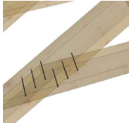
2* Połączenie krokwi z jętką
