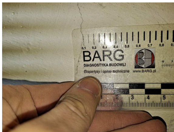
Rys. 16. Pomiar rozwartości zarysowania – 0,1 mm
