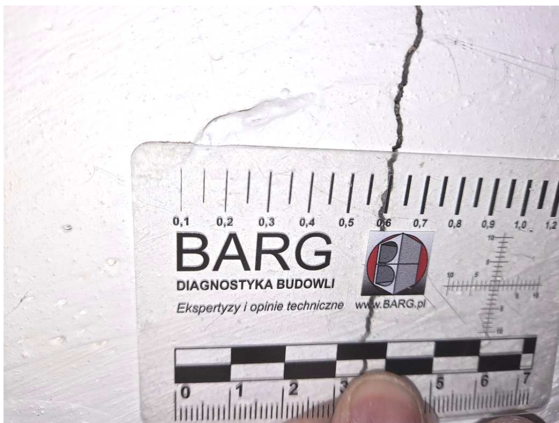
Rys. 20. Pomiar rozwartości zarysowania – 0,6 mm
