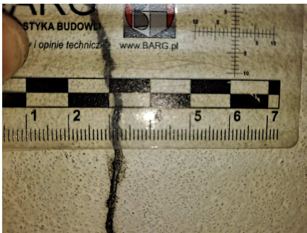
Rys. 21. Pomiar rozwartości zarysowania – 2 mm
