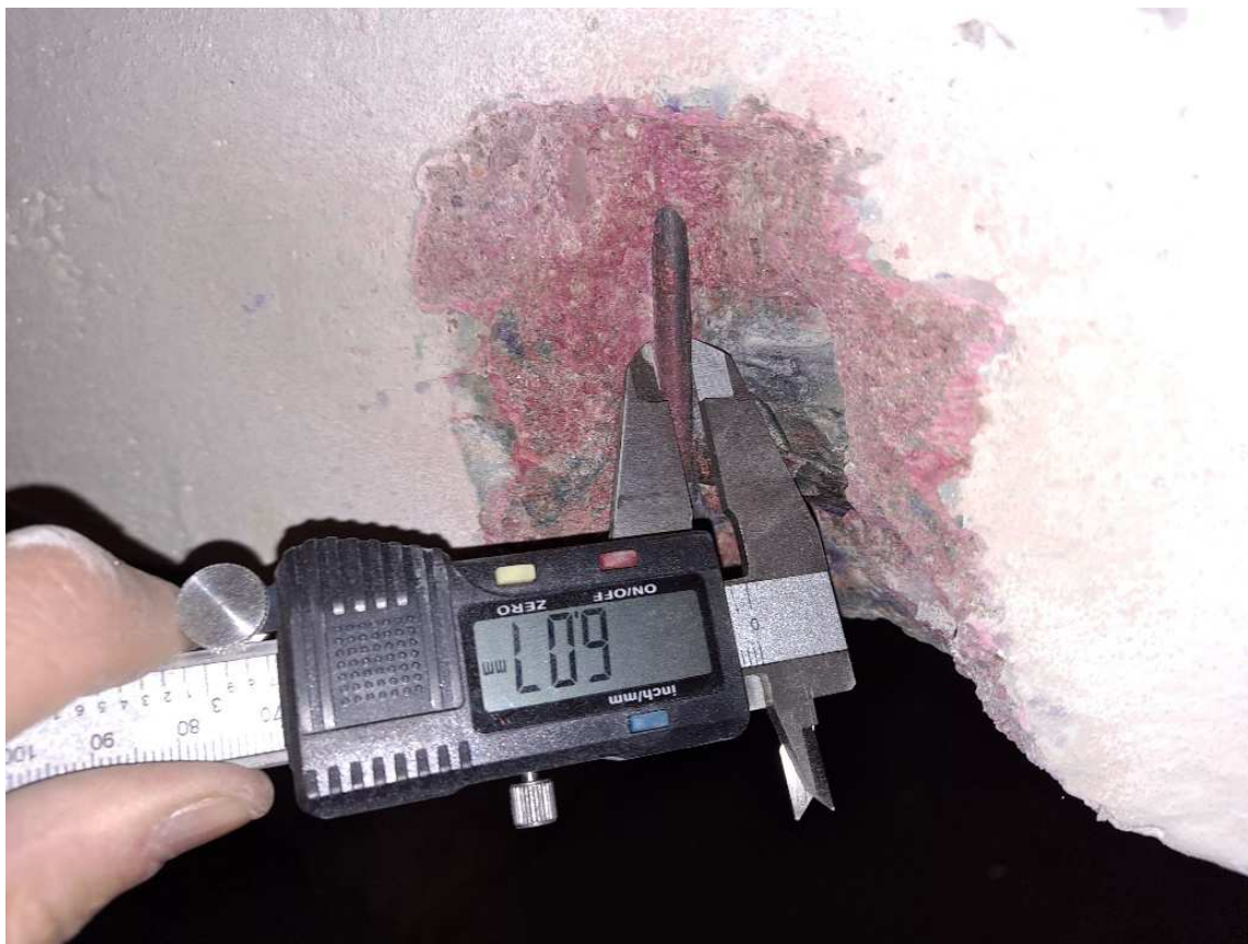
Rys. 51. Pomiar średnicy strzemion w belce – \Phi 6 mm
