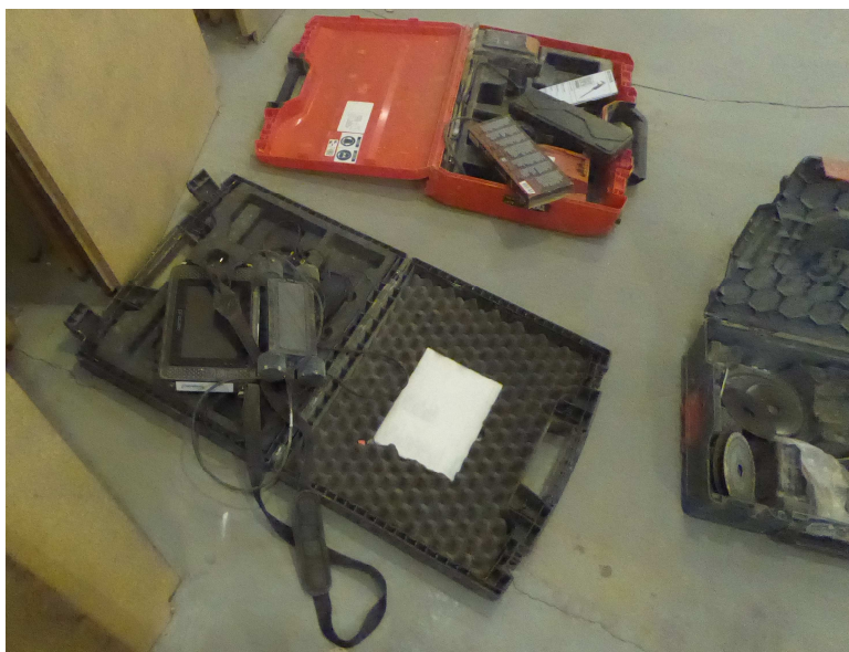
Rys. 40. Detektor zbrojenia Profometer 650AI firmy Proceq
