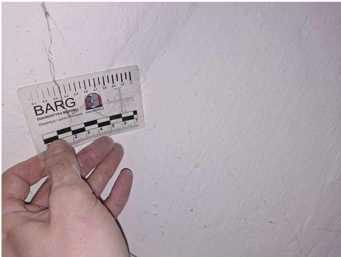
Rys. 18. Pomiar rozwartości zarysowania – 0,35 mm
