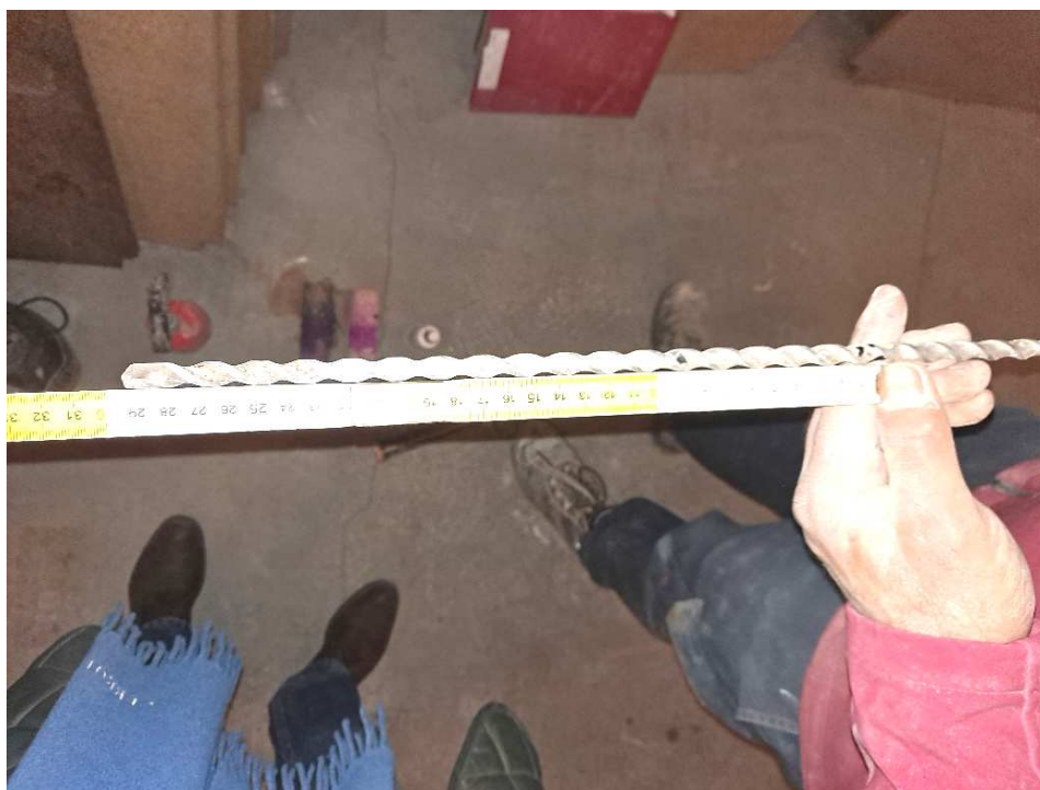
Rys. 26. Pomiar grubości wszystkich warstw stropu – ok. 29 cm
