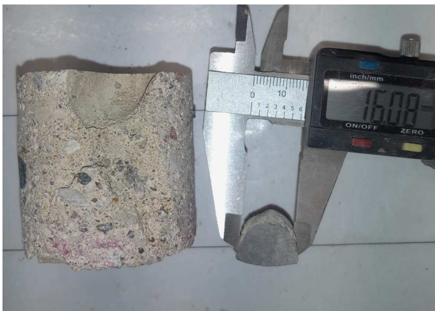
Rys. 33. Pomiar maksymalnej średnicy kruszywa na odwiercie nr 2
