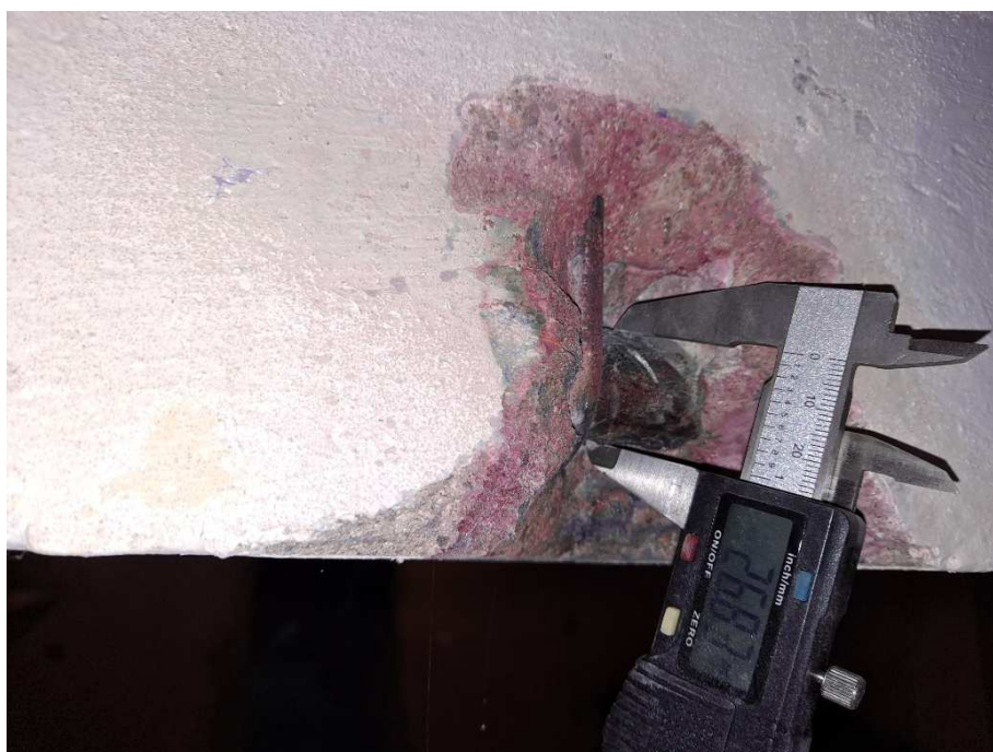
Rys. 50. Pomiar średnicy głównego zbrojenia belki – \Phi 26 mm
