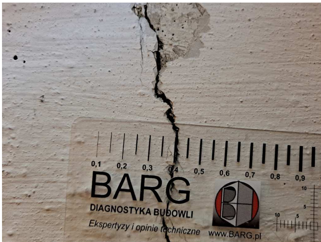
Rys. 19. Pomiar rozwartości zarysowania – 0,4 mm
