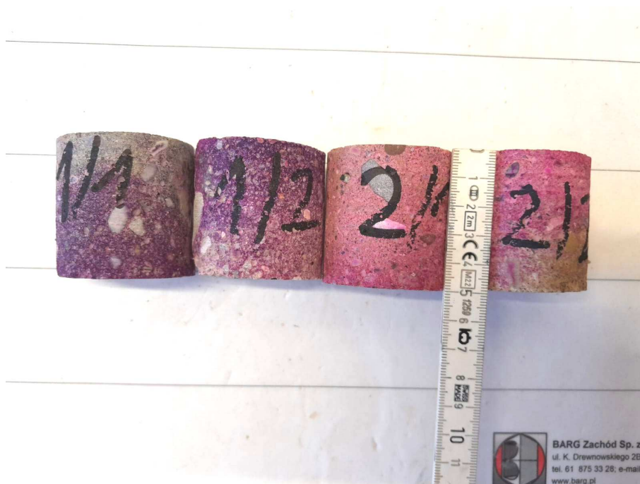
Rys. 30. Próbki przygotowane do badań wytrzymałościowych
