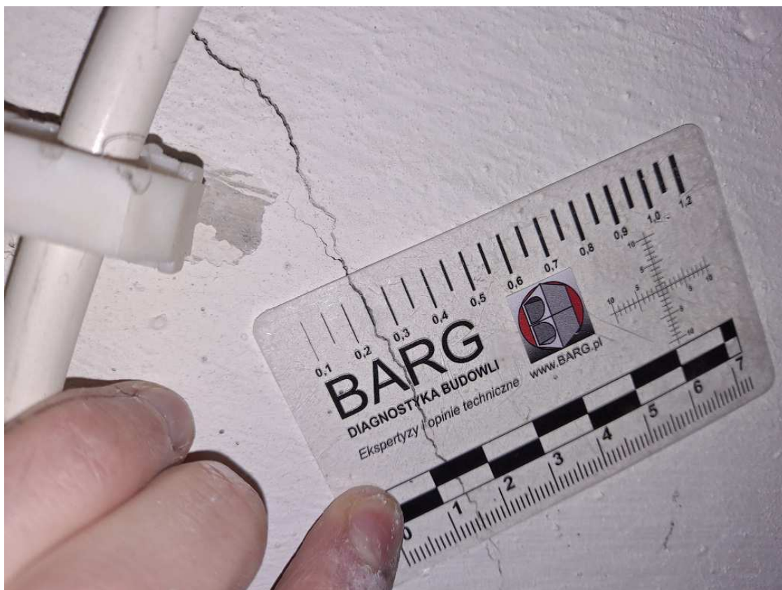
Rys. 17. Pomiar rozwartości zarysowania – 0,25 mm
