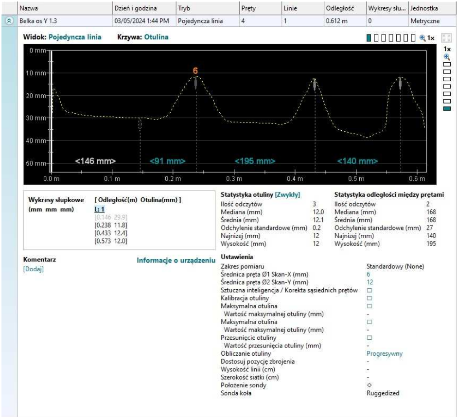
Rys. 46. Rozstaw strzemion w belce w pozostałych strefach
