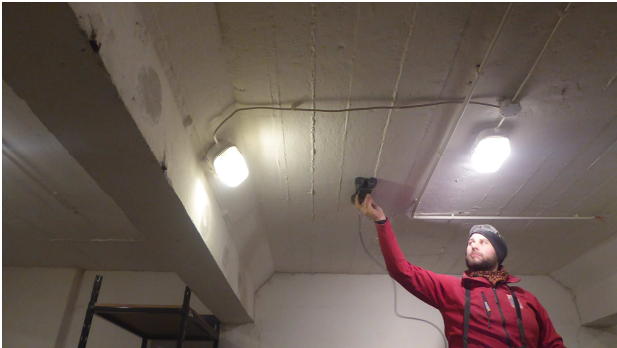
Rys. 41. Skanowanie analizowanego stropu w poszukiwaniu zbrojenia
