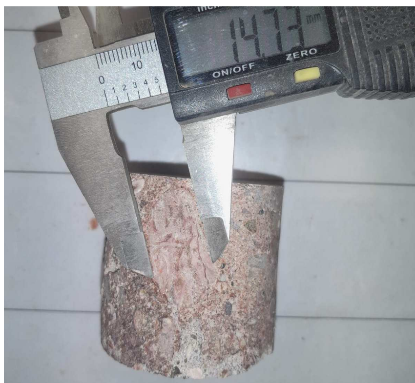
Rys. 32. Pomiar maksymalnej średnicy kruszywa na odwiercie nr 1
