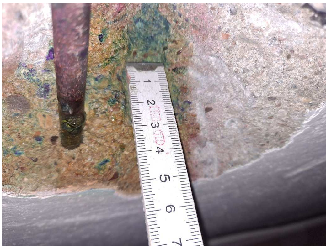
Rys. 37. Pomiar karbonatyzacji betonu w odkrywce nr 2 – płyta
