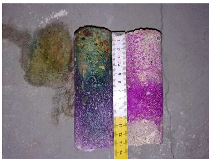
Rys. 35. Pomiar karbonatyzacji betonu na wykonanych próbkach rdzeniowych pobranych z belek żelbetowych. Po lewej stronie zastosowano test tęczyowy a po prawej fenoloftaleinę. Jak widać w obu przypadkach brak karbonatyzacji
