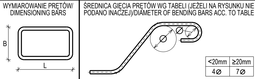
PODSTAWOWE PARAMETRY ZBROJENIA/BASIC REINFORCEMENT PARAMETERS
