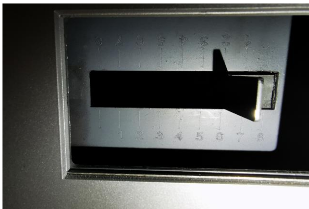
Rysunek 10. Ustawienie ilości powietrza pierwotnego
