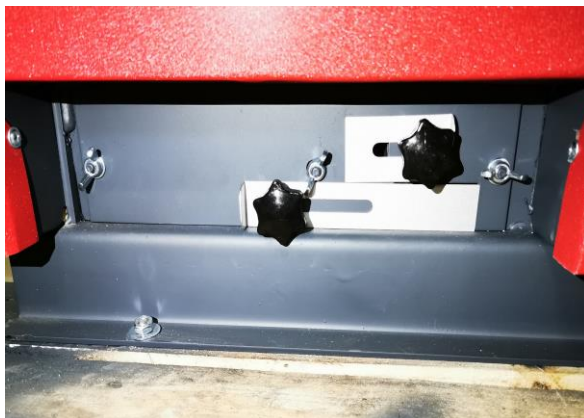
Rysunek 9. Lokalizacja przeston doprowadzających powietrze wtórne
