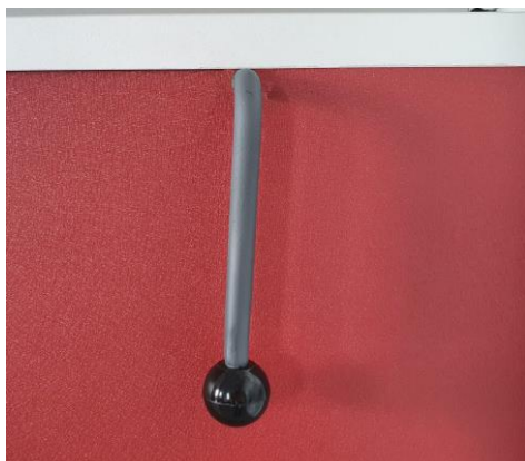
Rysunek 8. Dźwignia klapki krótkiego obiegu w pozycji zamkniętej.
