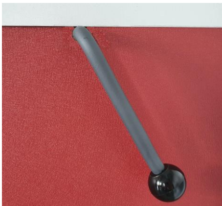
Rysunek 7. Dźwignia klapki krótkiego obiegu w pozycji otwartej.
