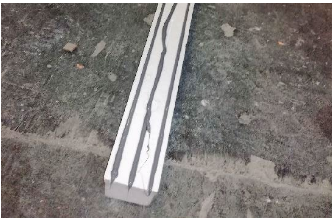
Zdjęcie nr 15 – trzy ścieżki hybrydy na belce BP Połączenie w strefie podprogowej belki BP z belkami CBM
