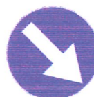
C-9 600 mm lico z folii odblaskowej I lub II typu
