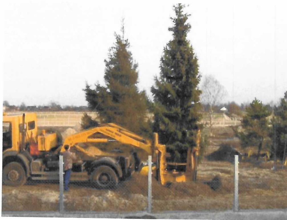
Ryc. 15. Ilustracja procesu przesadzania drzewa iglastego (adekwatna sytuacja do omawianej w „Planie...”) przy zastosowaniu przesadzarki. (źródło. Oferta OLX)
