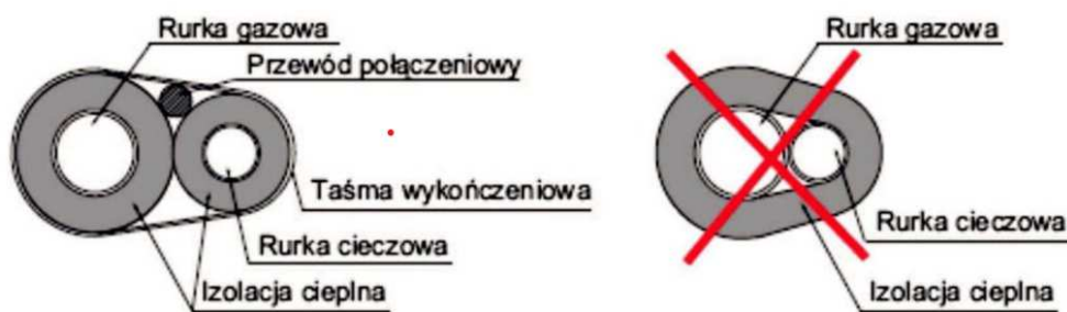
Rysunek 2 Sposób izolowania rurociągów
