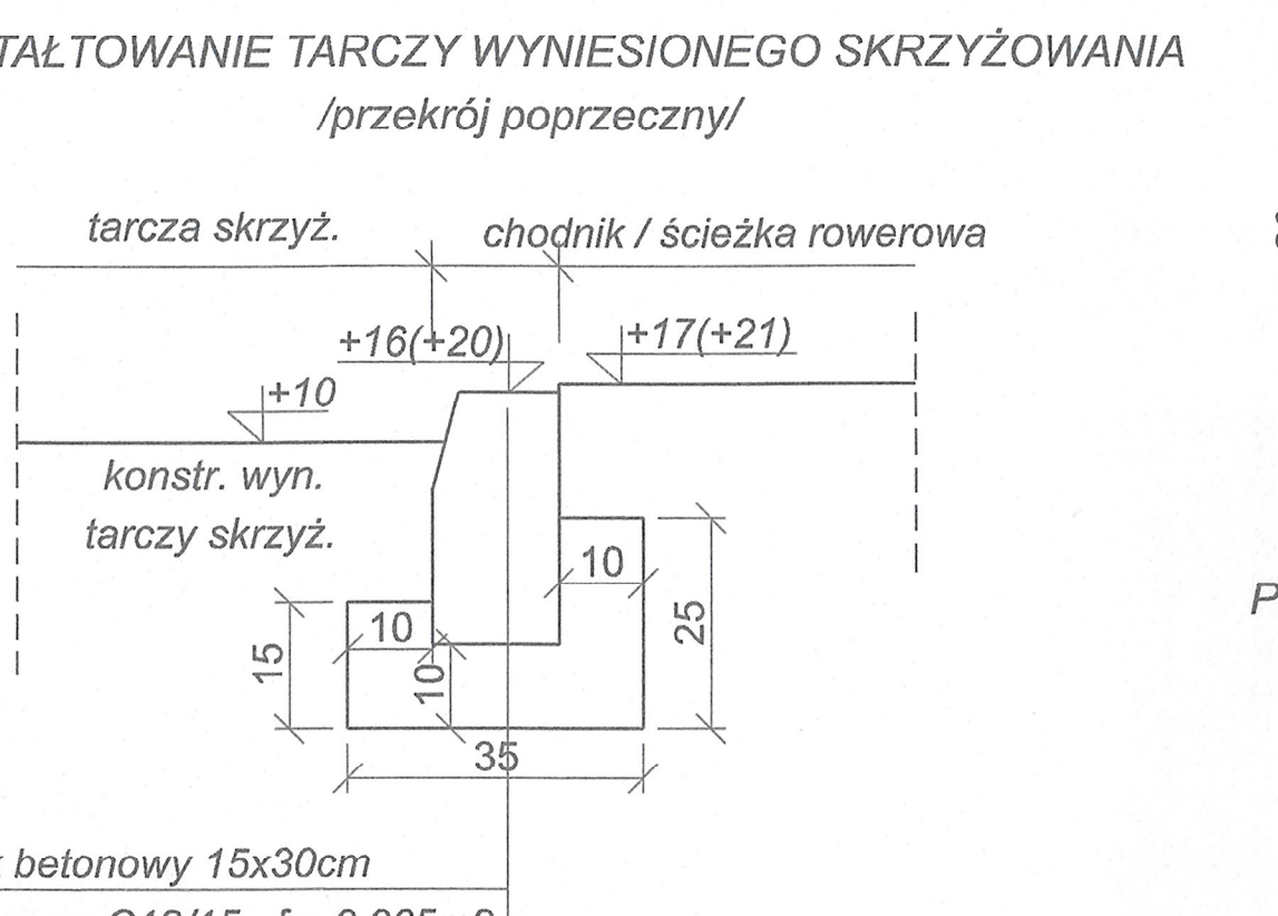
OGRANICZENIE KONSTRUKCJI JEZDNI NAJAZDOWEJ W REJONIE WYNIESIONEGO SKRZYŻOWANIA
