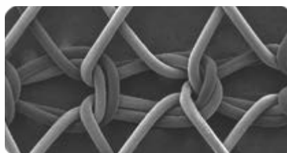
Konstrukcja siatki o otwartych porach, po absorpcji (25x)
